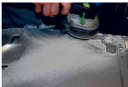
Ein Exzentrerschleifer beschädigt die Blechoberfläche noch am wenigsten.
