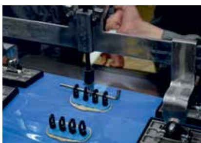
Mit den Klebebits werden die größten Verformungen beseitigt.
