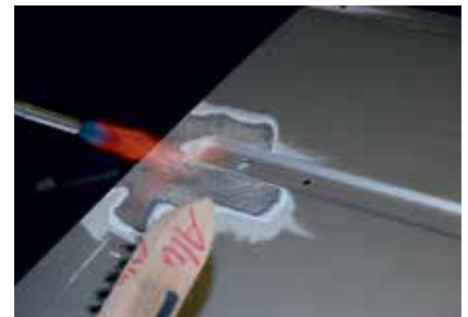
Die gute alte Drahtbürste bewährt sich weiterhin beim Blankmachen von Alu.
