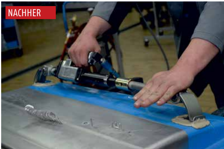
Mit der AiroPower-Druckluftpresse bringt der Profi verformte Blechteile schnell wieder auf die ursprüngliche Länge.
