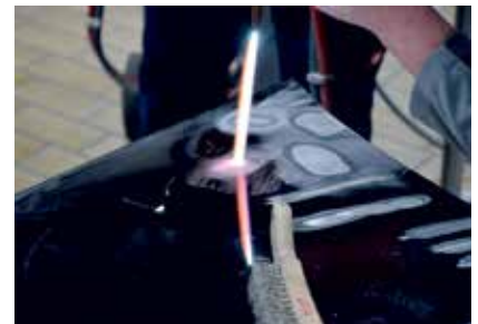
Mit weicher Brennerflamme rückt Rathmann Dellen und „Fröschen“ zuleibe.
